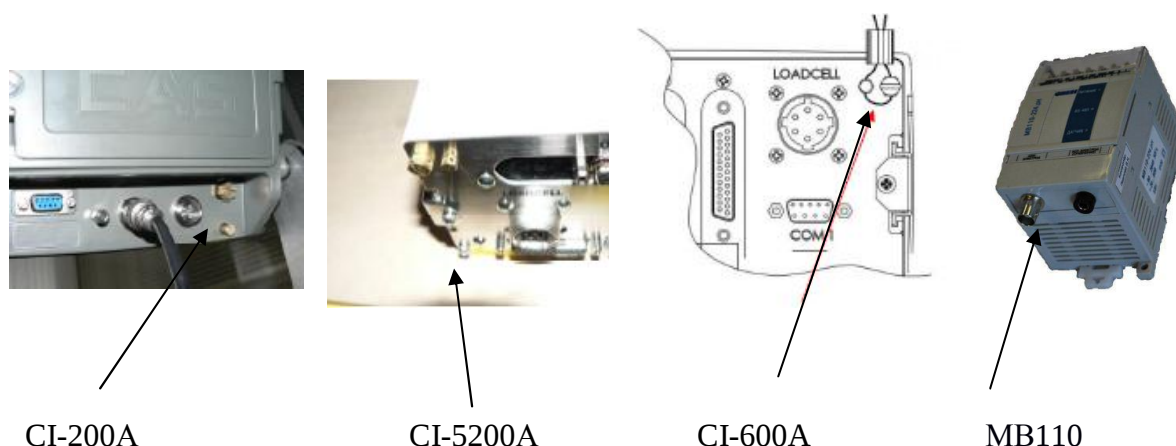
Рисунок 2 - Схемы пломбировки от несанкционированного доступа
